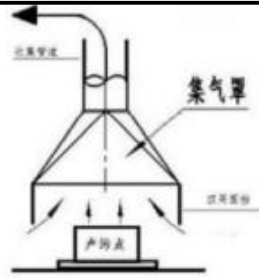
图 4-3 集气罩工程结构图
