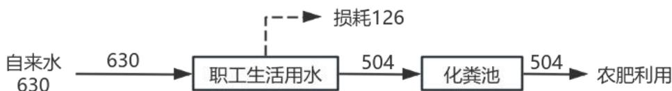
图2-1 本项目（全厂）水平衡图（单位t/a）
