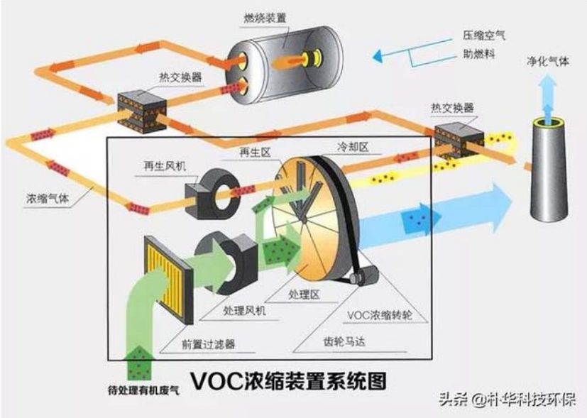
图 4-2 沸石分子筛吸附催化燃烧装置示意图
