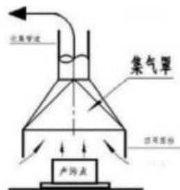
图 5-2 集气罩工程结构图
