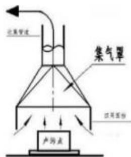
图 4-2 集气罩工程结构图
